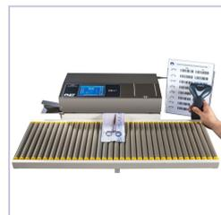
Soudeuse **TS 47T** avec table à rouleaux, SCAN et options USB et PRINTER
